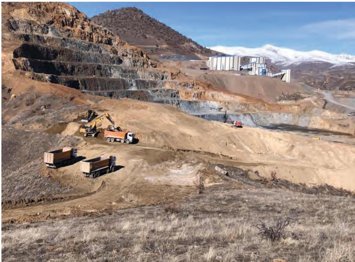
Проектом предусмотрена добыча карьерного материала со средним содержанием магнетита  $\text{Fe}_3\text{O}_4$  30% и производство из него концентрированной руды с содержанием магнетита  $\text{Fe}_3\text{O}_4$  45%. Полученная концентрированная руда поступает на погрузочную установку в Хасанчелеби и по железной дороге и направляется на завод по производству окатышей в Дивриги.
