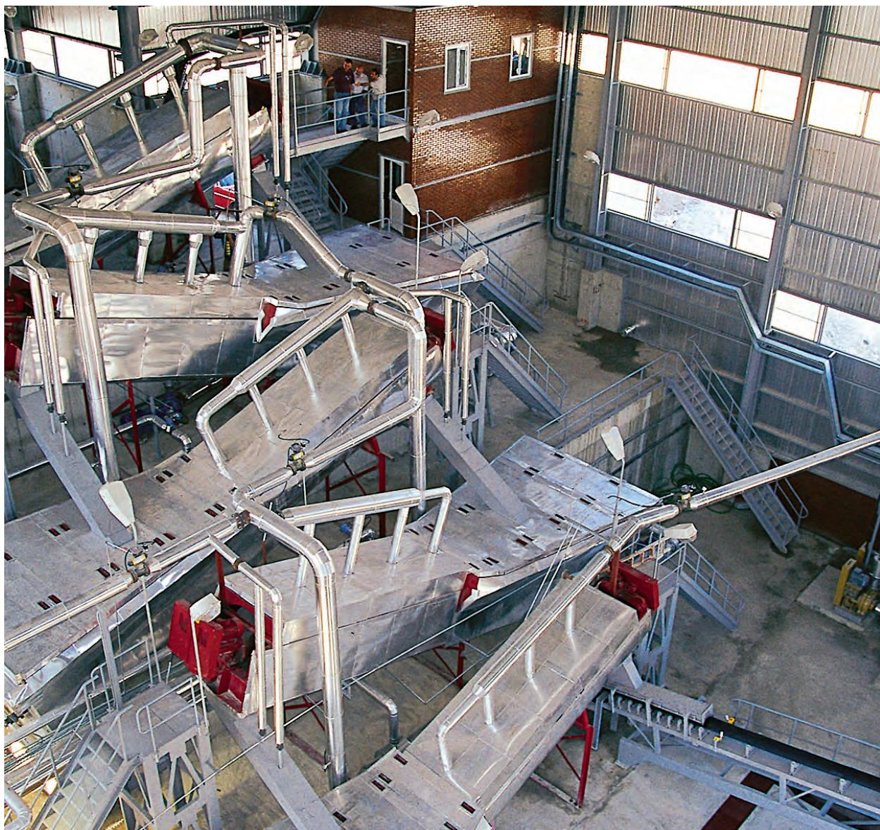
Saatte 70 ton çözme kapasitesine sahip olan, Kırka Tüvenan Tinkal Çözme Ünitesi'nin, tüm teknolojik ve detay projeleri, mühendislik hizmetleri, inşaat işleri, makine, elektrik, otomasyon imalat ve temin işleri,
