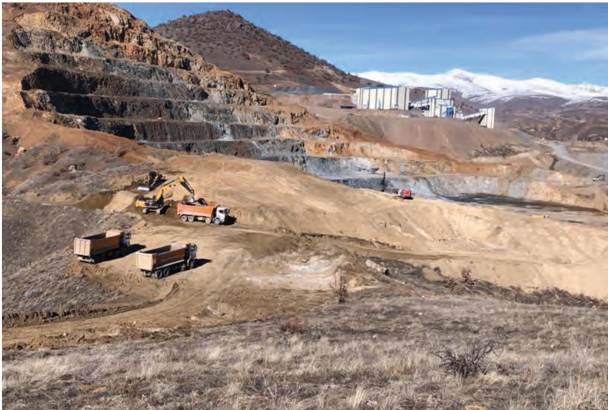
Proje kapsamında, Hasançelebi Demir Madeni Sahası'nda dekapaj yapılarak, ortalama %30 Fe<sub>3</sub>O<sub>4</sub> Manyetit içerikli Tüvenan Cevher üretimi yapılacaktır. Üretimi yapılan Tüvenan Cevher Kırma-Eleme ve Zenginleştirme Tesisi'ne beslenecek ve ortalaması %45 Fe<sub>3</sub>O manyetit içerikli olan Ön Konsantre Cevher elde edilecektir. Elde edilen Ön Konsantre Cevher Hasançelebi Yükleme Rampası'na taşınacak ve vagonlar ile Divriği Peletleme Tesisi'ne teslim edilecektir.
